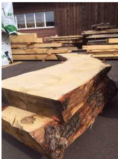
Afbeelding 2: De kromme eik is het basismateriaal voor de "krommer" (spantbeen)
